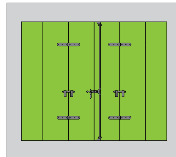
Vista frontale interna Chiusura con spagnoletta più blocca anta
